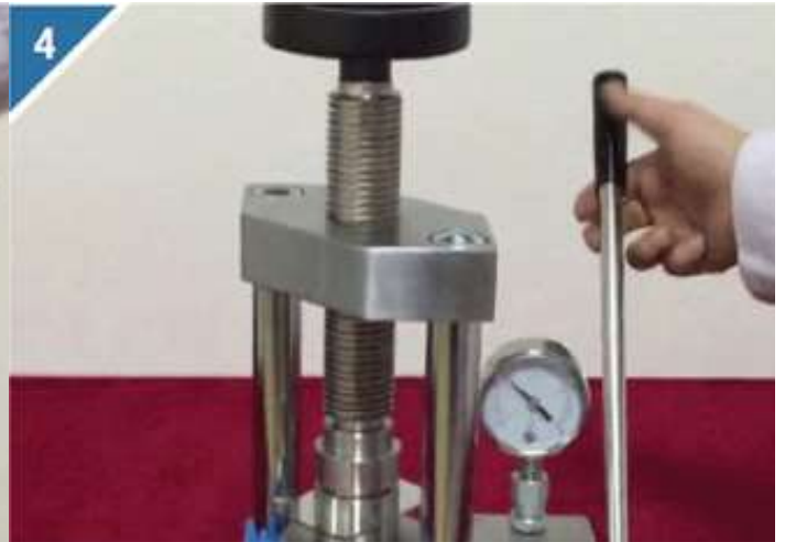
4、上下摇动压机手柄，达到所需压力。
