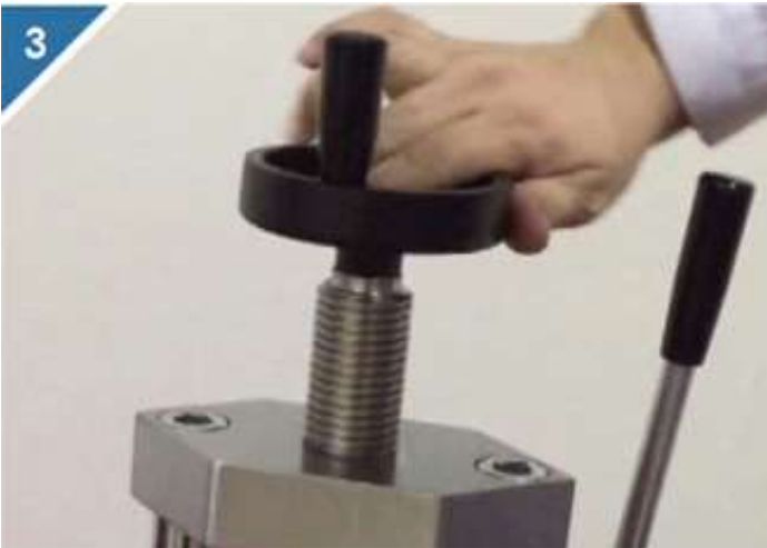
3、旋紧丝杠，将模具固定住。
