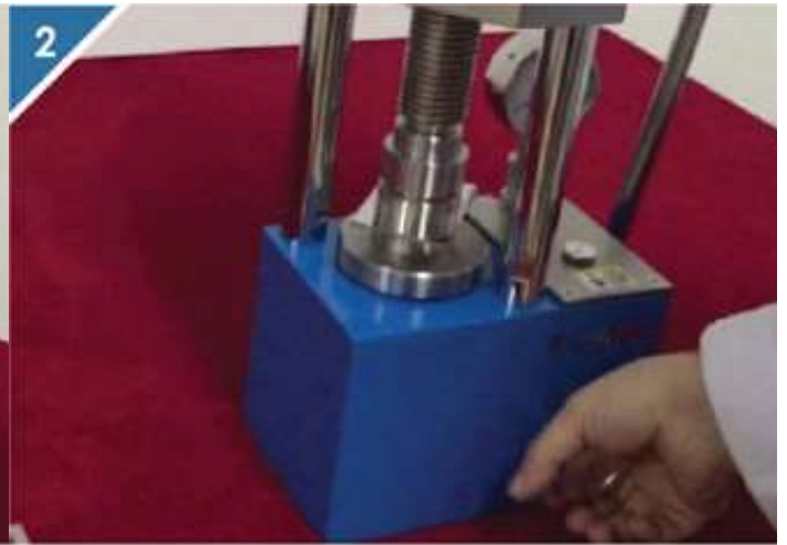
2、顺时针拧紧压片机放油阀门。
